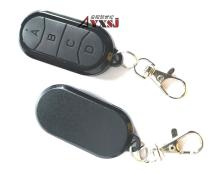
4 键无线遥控器 406A(学习码)/406B(固定码)是我公司 2020 年 7 月开发的一款外形设计新颖,性能稳定的小功率无线遥控器,内部采用 RF112B 编码发射芯片,芯片内置晶振,极少几个外围零件,发射频率为 433M/315M,频率稳定,发射效率高,可以用来做电瓶车遥控锁及各种短距离无线遥控产品使用。
